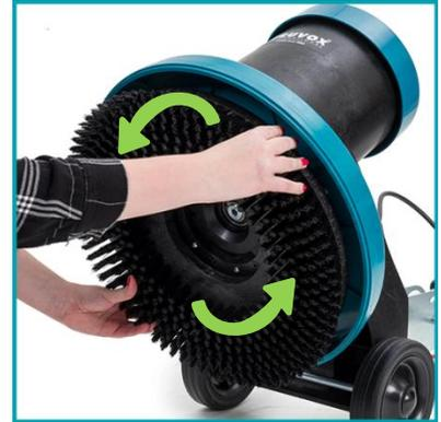
Fixez le plateau ou la brosse sur l'enclencheur. Tournez dans le sens inverse des aiguilles d'une montre jusqu'à ce qu'il soit parfaitement positionné.
