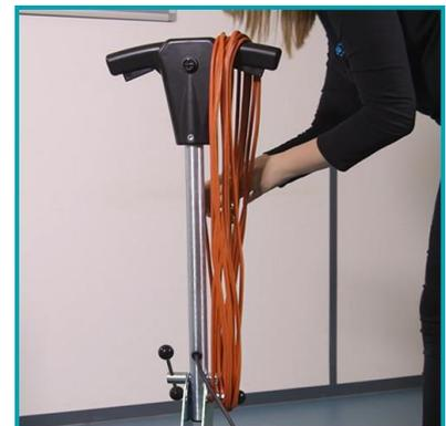
Enroulez le câble d'alimentation autour de la poignée de timon et de l'enrouleur de câble en vous assurant que la prise ne traîne pas au sol. Stocker la machine dans un local sec et à température ambiante.
