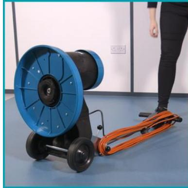
Basculer la machine vers l'arrière afin que celle-ci repose sur le sol et que l'enclencheur soit facilement accessible.
