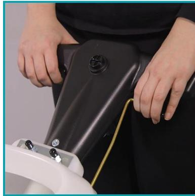
La pulvérisation de solution est contrôlée par le levier gauche. Tirer sur le levier pour libérer la solution et relâchez le levier pour arrêter le débit. Utilisez la machine normalement en libérant la solution selon les besoins de vos travaux.
