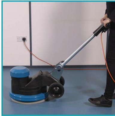
L'utilisation des Orbis Eco est pendulaire ; vous allez lever ou baisser légèrement le timon pour faire passer la machine de droite à gauche. Abaisser le timon augmente la pression sur l'arrière de la brosse/ plateau, ce qui va déplacer la machine vers la gauche.
